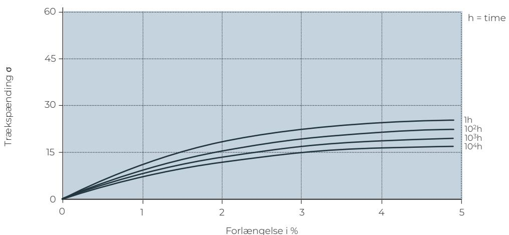
Isochrone kurver angiver materialekonstanter ved statiske belastninger under forhold, hvor der ud over belastning og temperaturer også tages hensyn til den meget vigtige tidsfaktor. Kurverne kan anvendes til at aflæse såvel krybeforhold (1. konstant belastning) som relaxationsforhold (2. konstant deformation).
